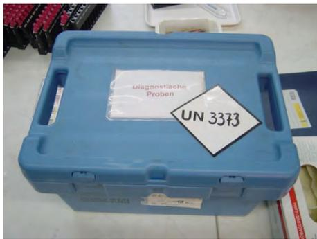
Abb. 29: Transportbox für den Versand diagnostischer Proben
