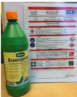
Abb. 28: Für jeden Gefahrstoff – hier eine brennbare Flüssigkeit – ist eine Betriebsanweisung zu erstellen. Sehr viele Gefahrstoffe sind auch in Gruppenbetriebsanweisungen zusammengefasst.
